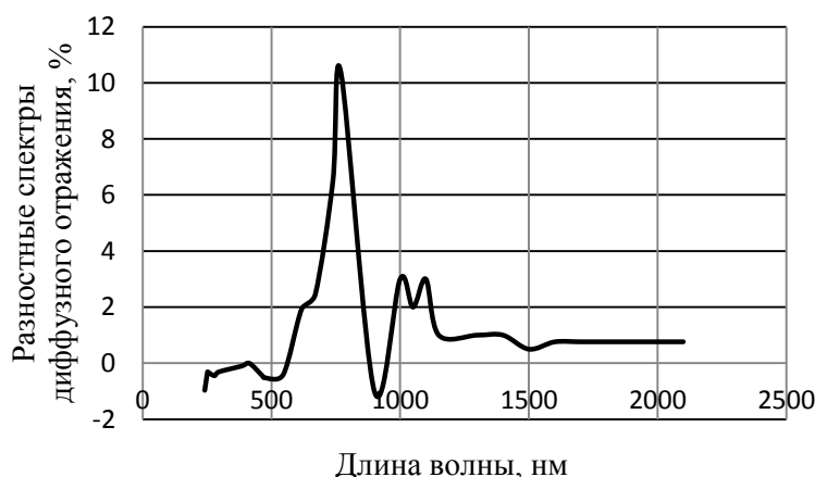
Рис. 2. Кривая зависимости разностных спектров диффузного отражения полиалканимида облучения электронами от длины волны
